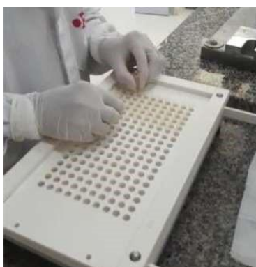
Figura 6. Inserção das cápsulas externa na placa de encapsulação.
