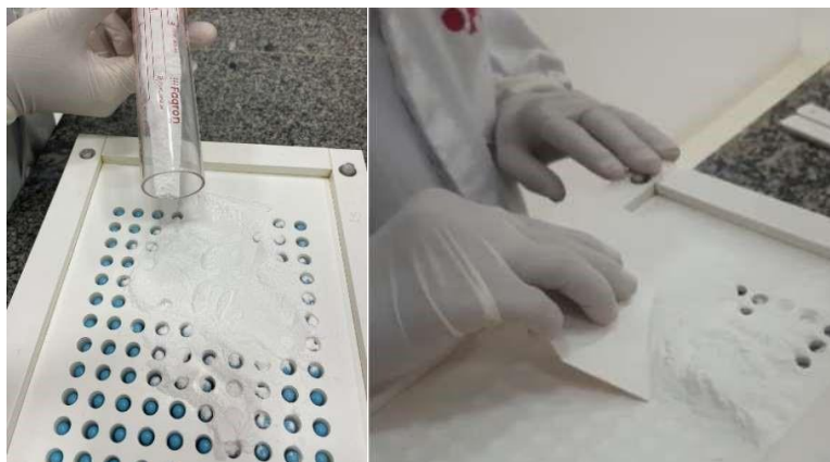
Figuras 9 e 10: preenchimento das cápsulas externas com a sua respectiva formulação.
